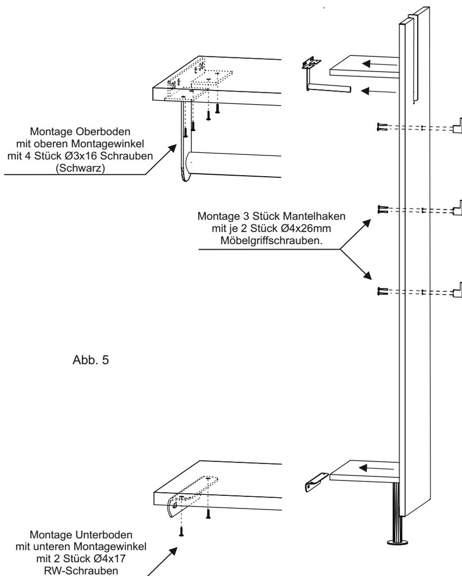
11. Verschrauben Sie den oberen Boden mit den oberen Montagewinkel mit 4 Stück Ø3x16 Schrauben (Schwarz) sowie den unteren Boden mit 2 Stück Ø4x17 RW-Schrauben. (Abb. 5)
