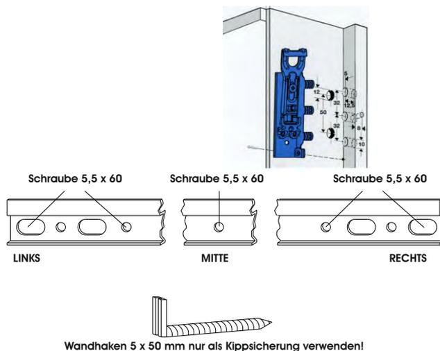
Die Typen **7141 / 7142** werden mittels eines Winkels gegen das Kippen nach vorne gesichert. Hierzu demontieren Sie zunächst den Schubkasten (Abb.:1). Der Kippsicherungswinkel ist werkseitig im oberen Bereich der Rückwand mittig montiert.
