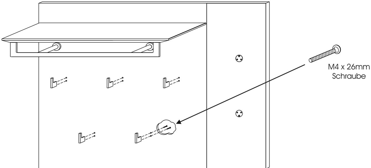
6. Auf der Applikation werden Hirnholzscheiben montiert. Diese werden von der Rückseite des Paneels mit zwei M4 x 26mm verschraubt.
