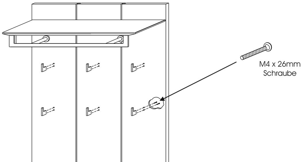
6. Positionieren Sie das Paneel an der Zimmerwand und legen das Maß der beiden Wand - Aufhängeschienen fest.
