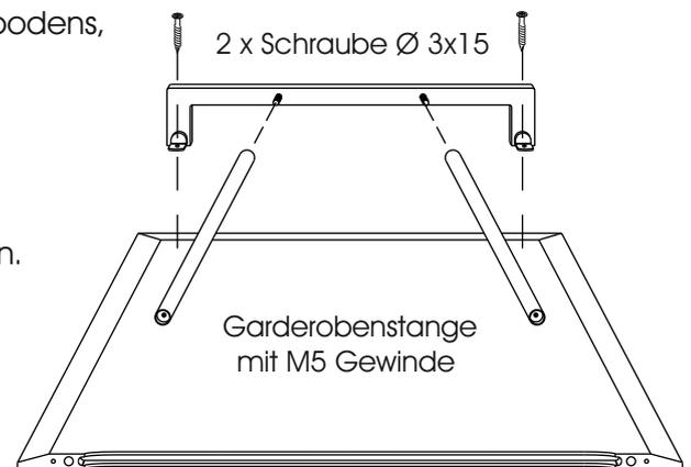
3. Verbinden Sie den Garderobenwinkel mit dem Ablageboden.
