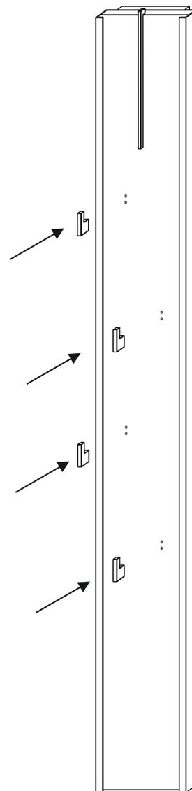
7. Zur Montage des Paneels an die Zimmerwand bohren Sie mit einem Ø8mm Bohrer entsprechend den Aufhängebeschlägen 3 Dübellöcher in die Wand. Hängen Sie nach Montage von Kunststoffdübeln und Hakenschrauben das Paneel auf. (Abb.6)
