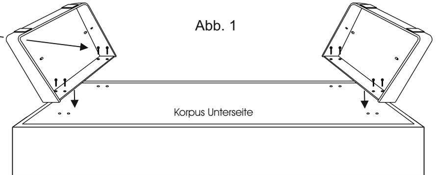
3. Schieben Sie auf die vier Kufenbolzen, auf denen später der Metallboden aufliegt, eine Kunststoffkappe auf. (Abb. 1)
