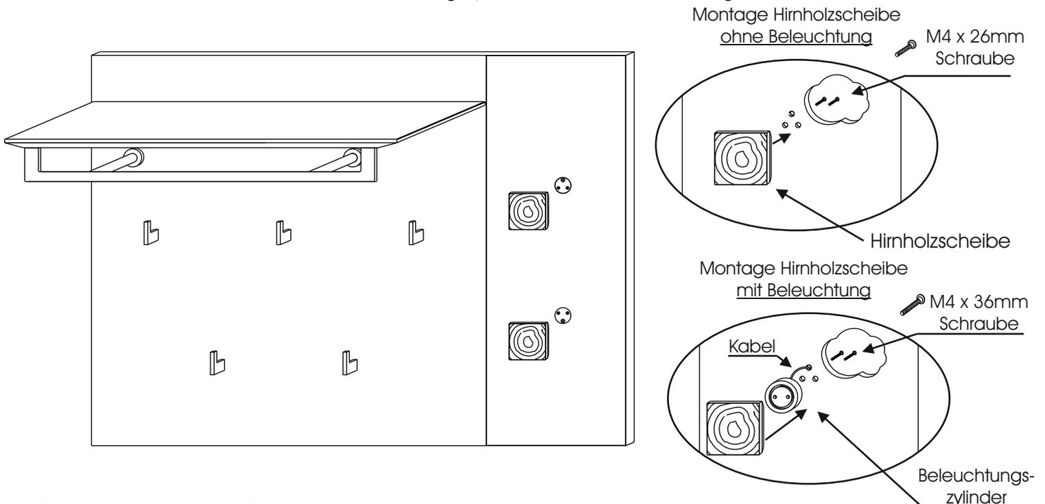
7. Positionieren Sie das Paneel an der Zimmerwand und legen das Maß der beiden Wand - Aufhängeschienen fest.
